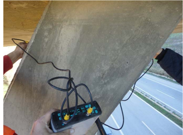
Φωτ. 8 Δοκιμή μέτρησης ταχύτητας υπερήχων (Άνω διάβαση νοσοκομείου Αιγίου).
