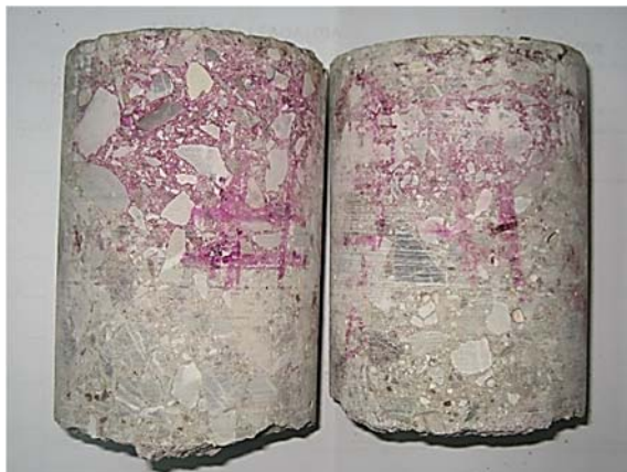
Φωτ. 11 Πυρήνες σκυροδέματος διαβρεγμένοι με διάλυμα φαινολοφθαλείνης (Άνω διάβαση νοσοκομείου Αιγίου).
