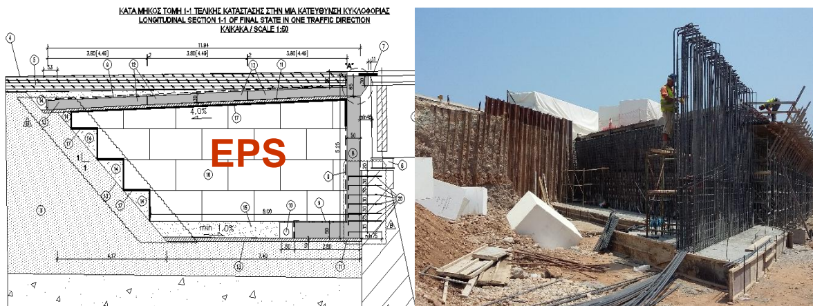
Σχ. 10 - Αντικατάσταση επιχώματος πίσω από τα ακρόβαθρα με ελαφρύ επίχωμα EPS. Η κατασκευή πραγματοποιείται ανεξάρτητα για κάθε κλάδο με χρήση αντιστήριξης μεταλλικών πασσαλοσανίδων.
